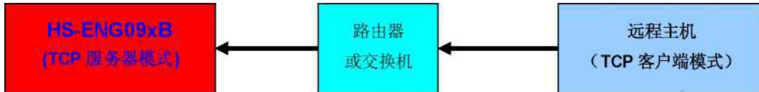
图 4.5 HS-ENG099POE 工作在 TCP 服务器模式的逻辑图
