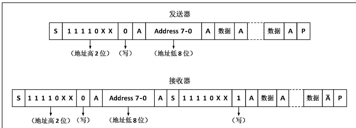
6) 发送模式时，主设备内部的移位寄存器将数据从数据寄存器发送到 SDA 线上，当主设备接收到 ACK 时，状态寄存器 1 (R16\_I2Cx\_STAR1) 的 TxE 被置位，如果 ITEVTEN 和 ITBUFEN 被置位，还会产生中断。向数据寄存器写入数据将会清除 TxE 位。
