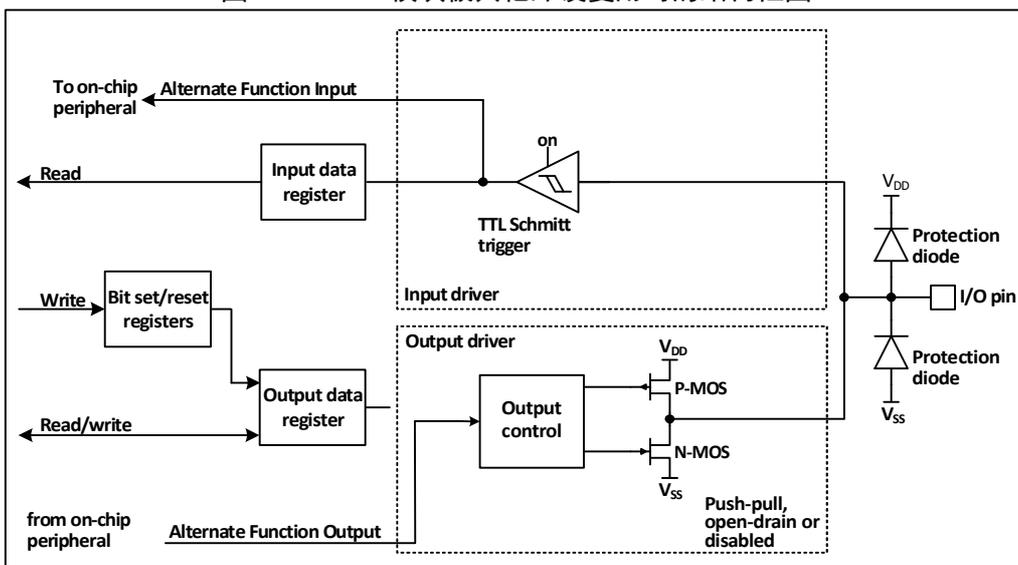
在启用复用功能时，输出驱动器被使能，可以按需要被配置成开漏或者是推挽模式，施密特触发器也被打开，复用功能的输入和输出线都被连接，但是输出数据寄存器被断开，出现在 IO 引脚上的
