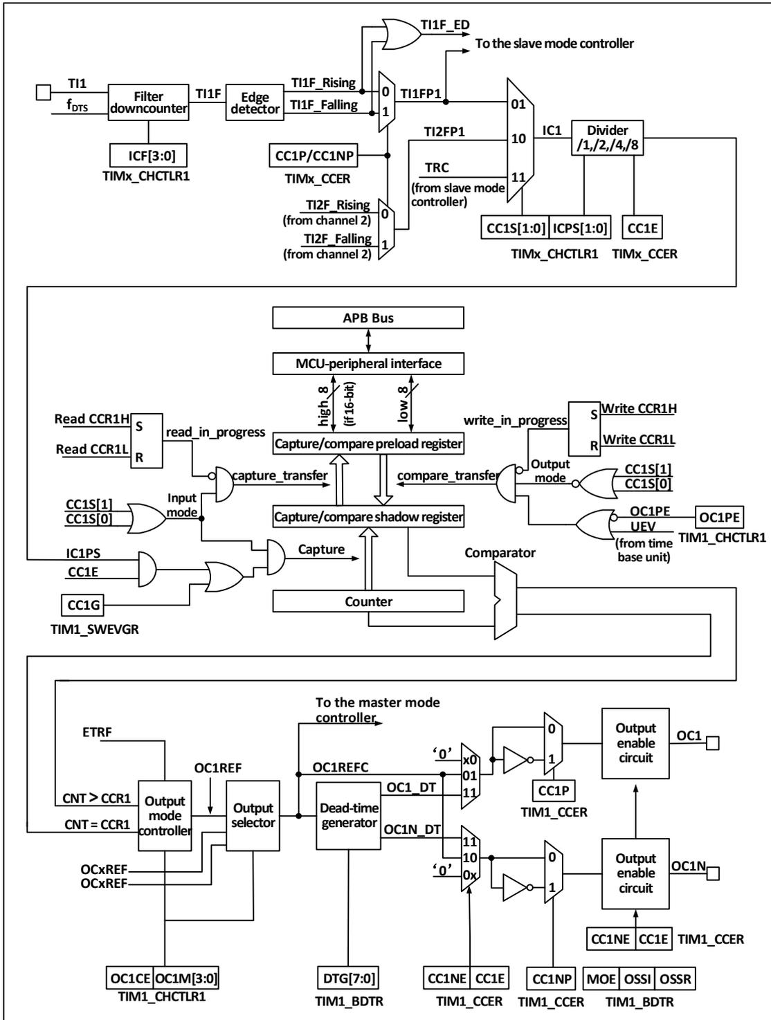
比较捕获通道的结构框图如图 14-3 所示。信号从通道 x 引脚输入进来后可选做为 TIx (TI1 的来源可以不只是 CH1, 见定时器的结构框图 14-1), TI1 经过滤波器 (ICF[3:0]) 生成 TI1F, 再经过边沿检测器分成 TI1F\_Rising 和 TI1F\_Falling, 这两个信号经过选择 (CC1P) 生成 TI1FP1, TI1FP1 和来自通道 2 的 TI2FP1 一起送给 CC1S 选择成为 IC1, 经过 ICPS 分频后送给比较捕获寄存器。
