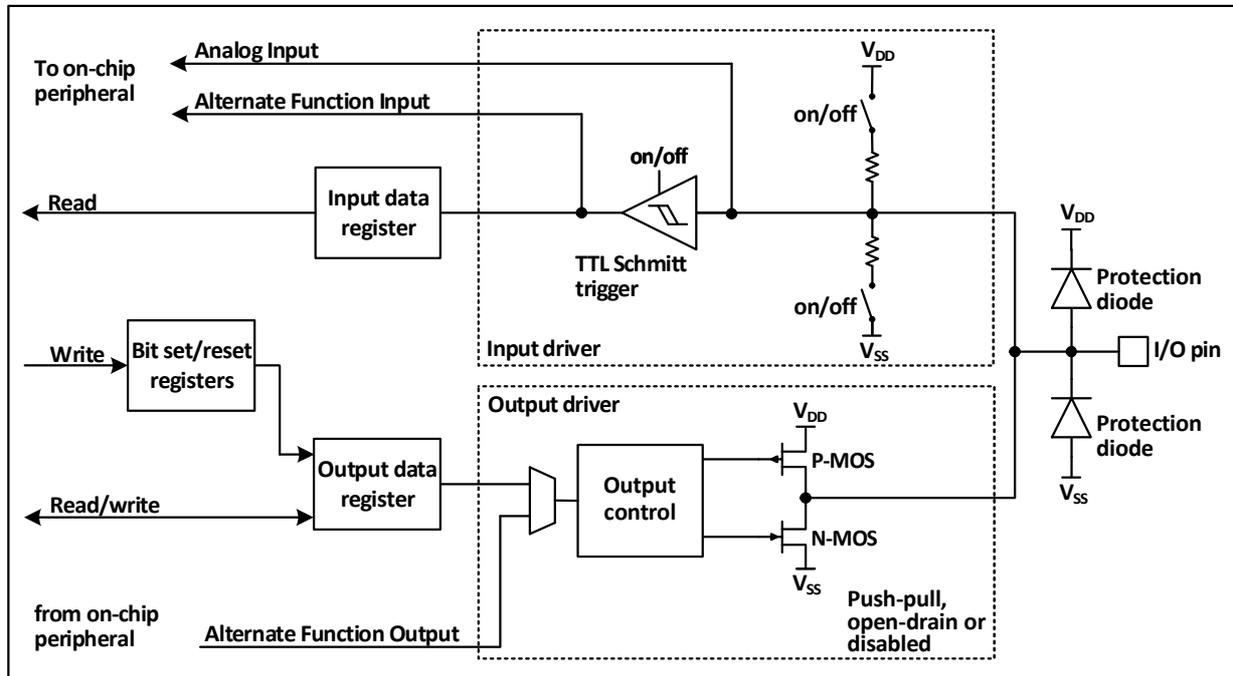
如图 10-1 所示 I/O 口结构，每个引脚在芯片内部都有两只保护二极管，I/O 口内部可分为输入和输出驱动模块。其中输入驱动有弱上下拉电阻可选，可连接到 AD 等模拟输入的外设；如果输入到数字外设，就需要经过一个 TTL 施密特触发器，再连接到 GPIO 输入寄存器或者其他复用外设。而输出驱动有一对 MOS 管，可通过配置上下的 MOS 管是否使能来将 I/O 口配置成开漏或者推挽输出；输出驱动内部也可以配置成由 GPIO 控制输出还是由复用的其他外设控制输出。
