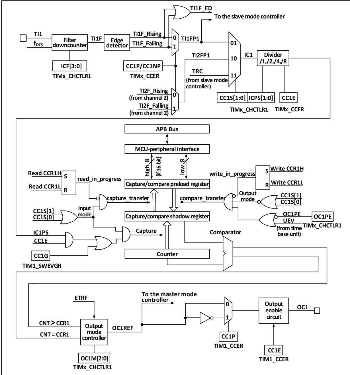
信号从通道 x 引脚输入进来后可选做为 TI<sub>x</sub> (TI1 的来源可以不只是 CH1, 见定时器的框图 14-1), TI1 经过滤波器 (ICF[3:0]) 生成 TI1F, 再经过边沿检测器分成 TI1F\_Rising 和 TI1F\_Falling, 这两个信号经过选择 (CC1P) 生成 TI1FP1, TI1FP1 和来自通道 2 的 TI2FP1 一起送给 CC1S 选择成为 IC1, 经过 ICPS 分频后送给比较捕获寄存器。
