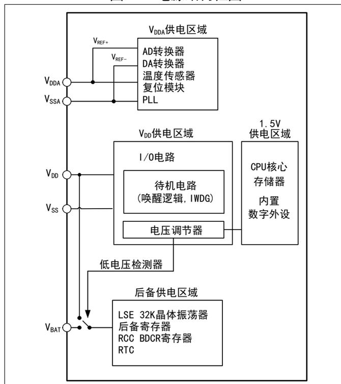
在主电源  $V_{DD}$  掉电后，模拟开关切换至  $V_{BAT}$ ，后备区域由  $V_{BAT}$  引脚供电，此时 PC13~15 无法作为 GPIO，仅可使用如下功能：
