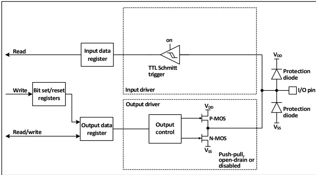
当 IO 口配置成输出模式时，输出驱动器中的一对 MOS 可根据需要被配置成推挽或者开漏模式，不使用复用功能。输入驱动的上下拉电阻被禁用，TTL 施密特触发器被激活，出现在 IO 引脚上的电平将会在每个 APB2 时钟被采样到输入数据寄存器，所以读取输入数据寄存器将会得到 IO 状态，在推挽输出模式时，对输出数据寄存器的访问就会得到最后一次写入的值。
