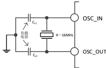
注：负载电容需要尽可能地靠近振荡器引脚，并根据晶体厂家参数选择容值。
