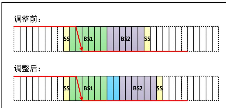
如图 22-7，SJW 为 2，总线电平跳变在时间段 1 被检测到，则需要延长时间段 1 的长度，最大延长 SJW，从而延迟采样点的位置。
