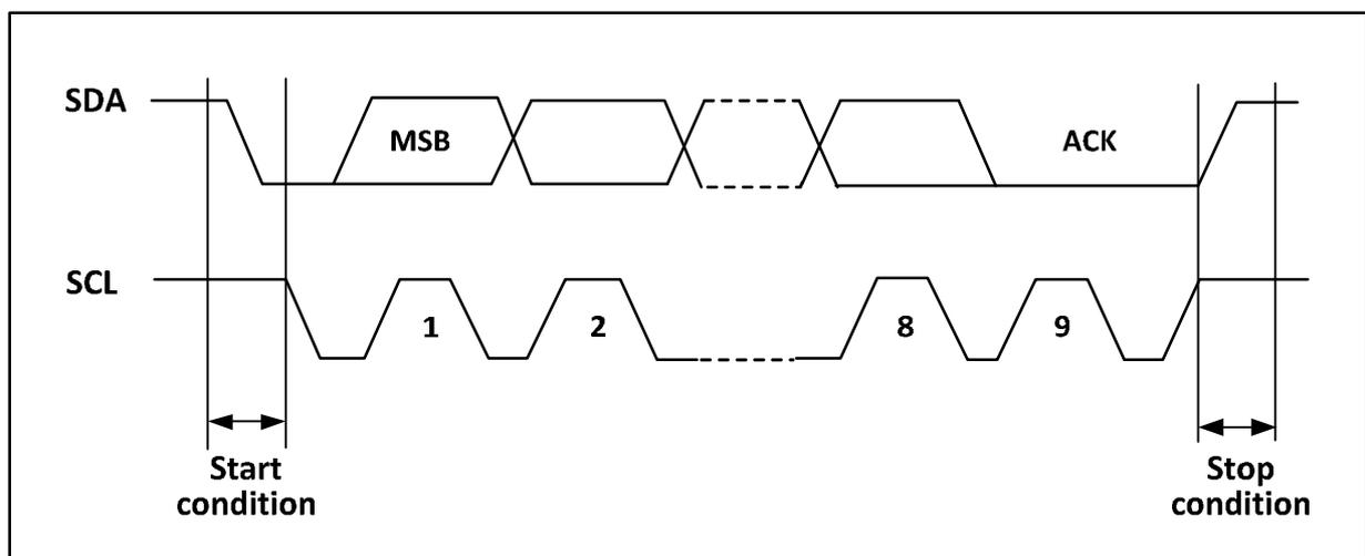
为了正常使用必须给 I2C 输入正确的时钟，其中标准模式下，输入时钟最低为 2MHz，在快速模式下，输入时钟最低为 4MHz。
