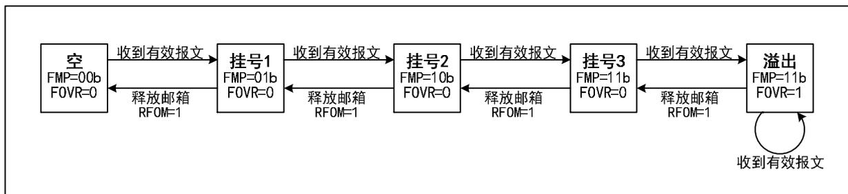
上文中的报文丢失情况，即接收 FIFO 为满，报文溢出导致报文丢失，接收 FIFO 寄存器 CAN\_RFIF0x 的 FOVR 位会硬件自动置 1，以供溢出查询。寄存器 CAN\_CTLR 的 RFLM 位置 1，则接收 FIFO 锁定功能启用，丢弃的报文为新接收报文；寄存器 CAN\_CTLR 的 RFLM 位清 0，则接收 FIFO 锁定功能停用，接收 FIFO 的三个原报文中，最后接收的报文会被新报文覆盖。
