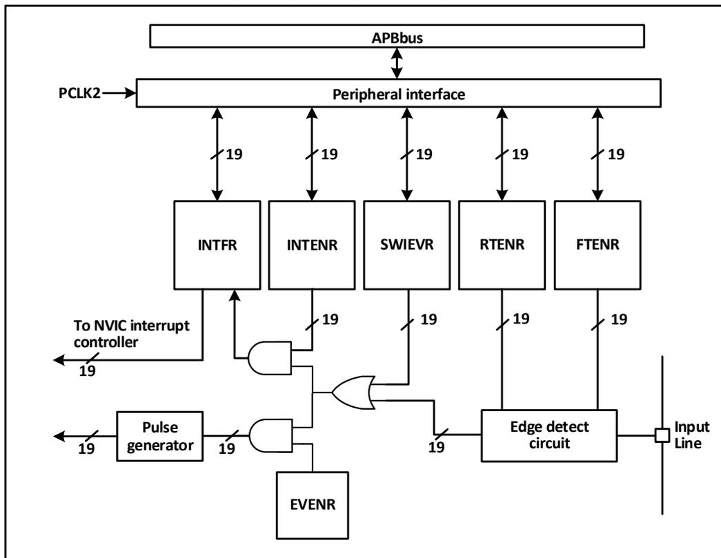
由图 9-1 可以看出，外部中断的触发源既可以是软件中断（SWIEVR）也可以是实际的外部中断通道，外部中断通道的信号会先经过边沿检测电路（edge detect circuit）的筛选。只要产生软中断或者外部中断信号其一，就会通过图中的或门电路输出给事件使能和中断使能两个与门电路，只要有中断被使能或者事件被使能，就会产生中断或者事件。EXTI 的六个寄存器由处理器通过 APB2 接口访问。
