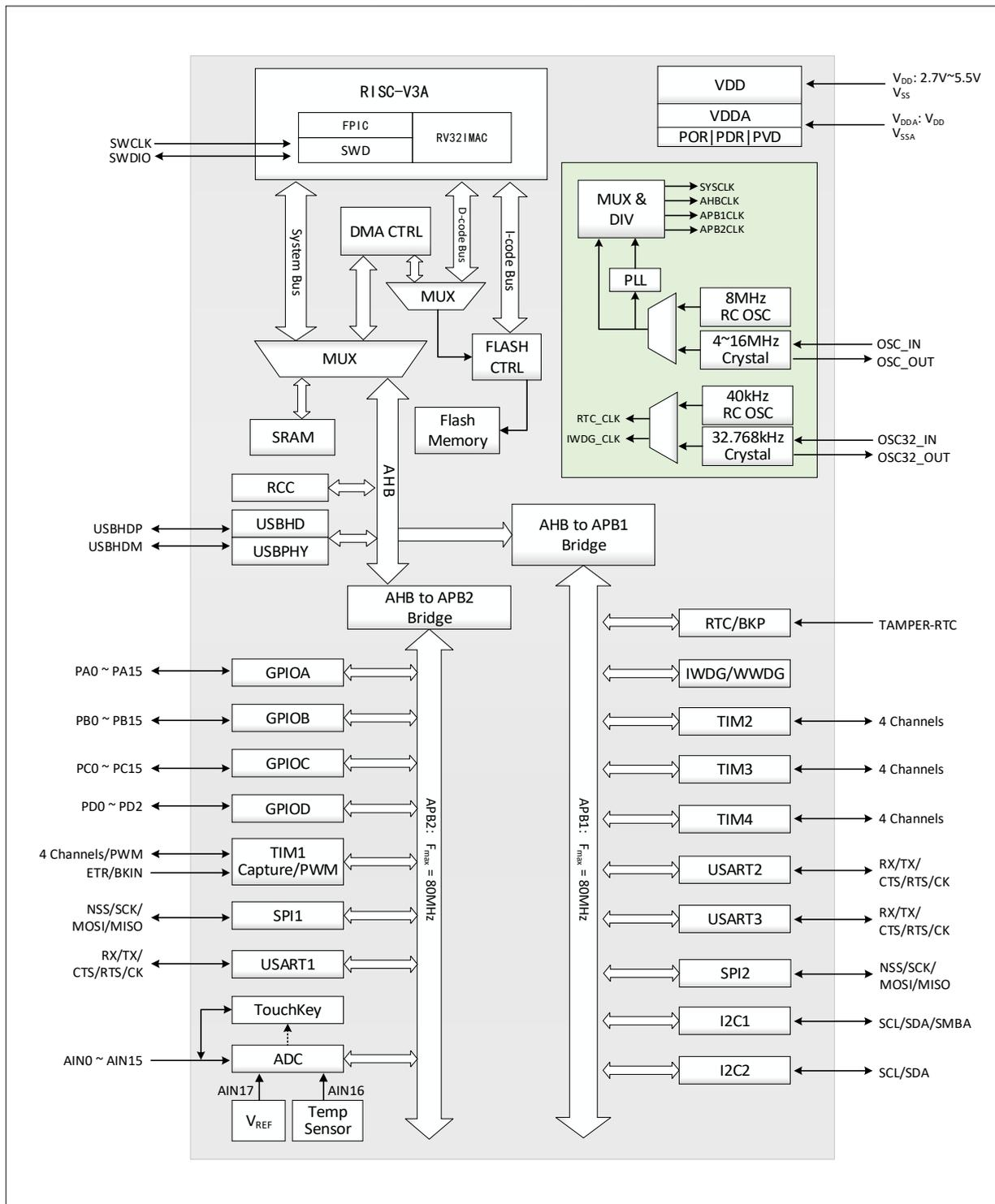
系统中设有：Flash 访问预取机制用以加快代码执行速度；通用 DMA 控制器用以减轻 CPU 负担、提高效率；时钟树分级管理用以降低了外设总的运行功耗，同时还兼有数据保护机制，时钟安全系统保护机制等措施来增加系统稳定性。
