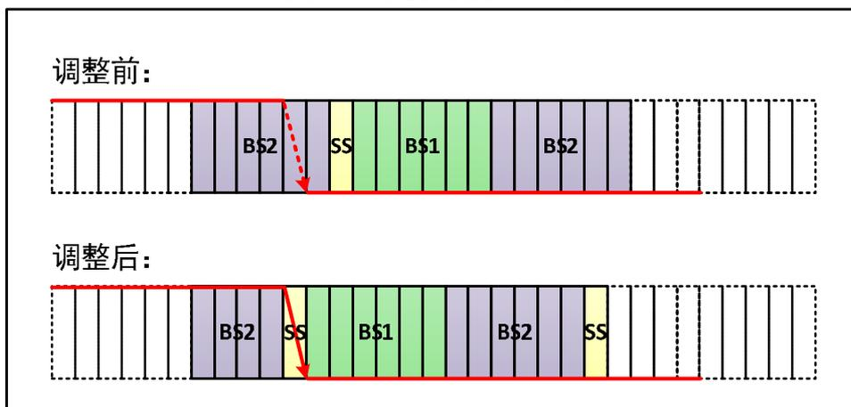
如图 22-8，SJW 为 2，总线电平跳变在时间段 2 被检测到，则需要缩小时间段 2 的长度，最大缩小 SJW，从而提前采样点的位置。
