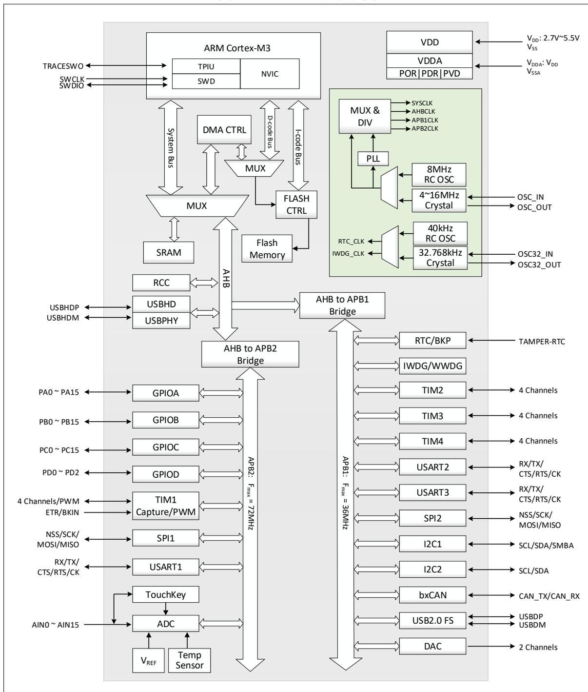
图 1-2 CH32V103 系统框图
