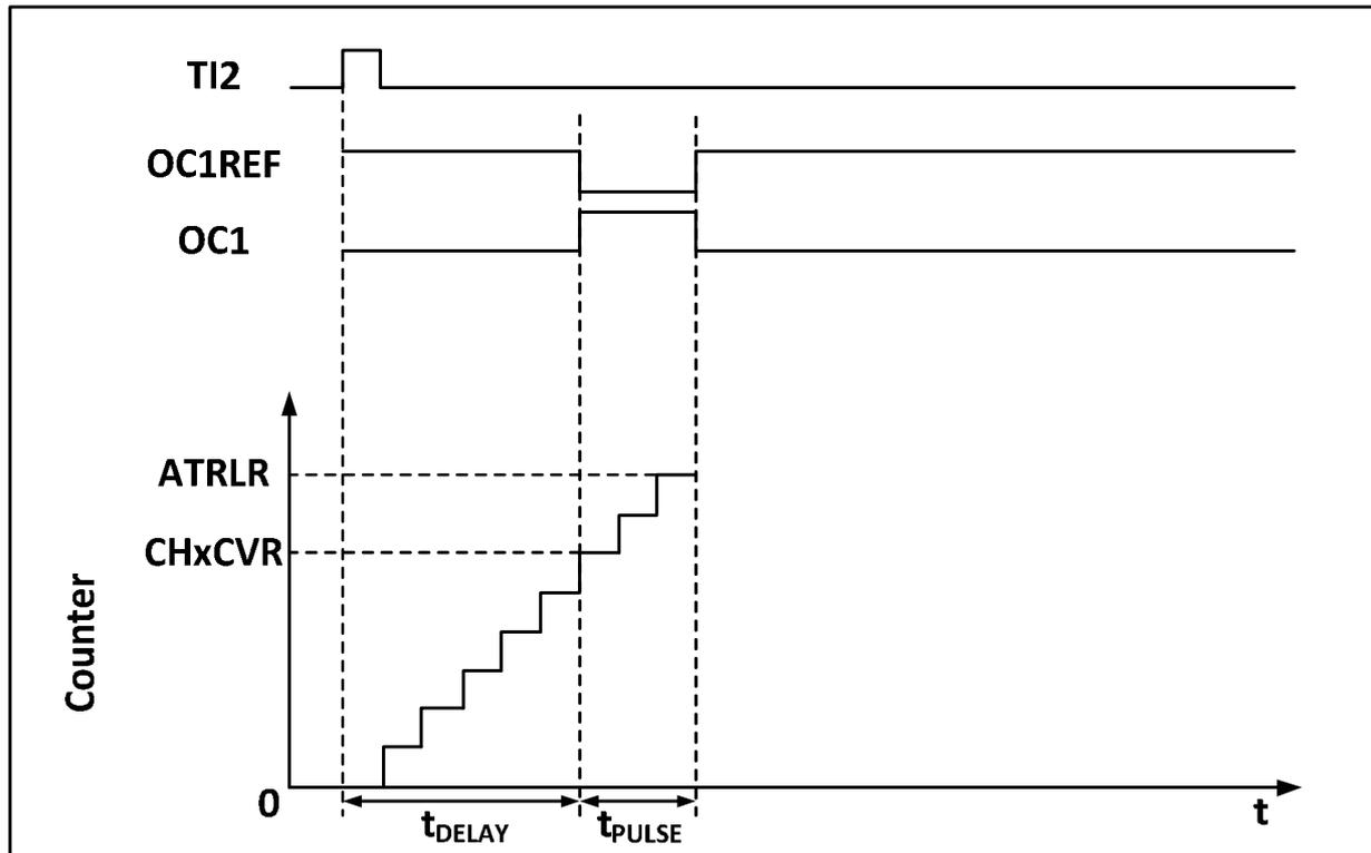
1) 设定 TI2 为触发。置 CC2S 域为 01b, 把 TI2FP2 映射到 TI2; 置 CC2P 位为 0b, TI2FP2 设为上升沿检测; 置 TS 域为 110b, TI2FP2 设为触发源; 置 SMS 域为 110b, TI2FP2 被用来启动计数器;
