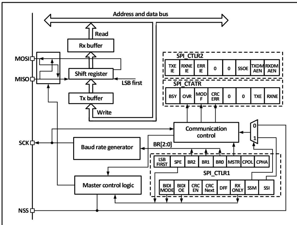
由图 19-1 可以看出，与 SPI 相关的主要是 MISO、MOSI、SCK 和 NSS 四个引脚。其中 MISO 引脚在 SPI 模块工作在主模式下时，是数据输入引脚；工作在从模式下时，是数据输出引脚。MOSI 引脚工作在主模式下时，是数据输出引脚；工作在从模式下时，是数据输入引脚。SCK 是时钟引脚，时钟信号一直由主机输出，从机接收时钟信号并同步数据收发。NSS 引脚是片选引脚，有以下用法：
