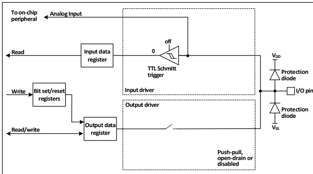
在启用模拟输入时，输出缓冲器被断开，输入驱动器中的施密特触发器的输入被禁止以防止产生 I/O 口上的消耗，上下拉电阻被禁止，读取输入数据寄存器将一直为 0。
