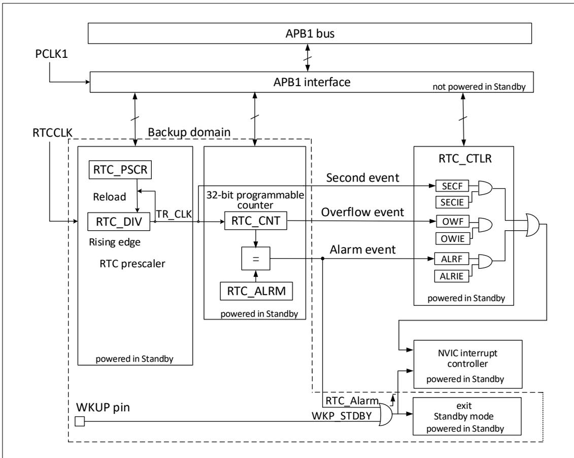
由图 6-1 所示, RTC 模块主要是 APB1 总线接口、分频器和计数器、控制和状态寄存器三部分组成, 其中分频器和计数器部分在后备区域, 可由  $V_{BAT}$  供电。RTCCK 输入分频器 (RTC\_DIV) 之后, 被分频成 TR\_CLK。值得注意的是, 分频器 (RTC\_DIV) 的内部是一个自减计数器, 自减到溢出就会输出一
