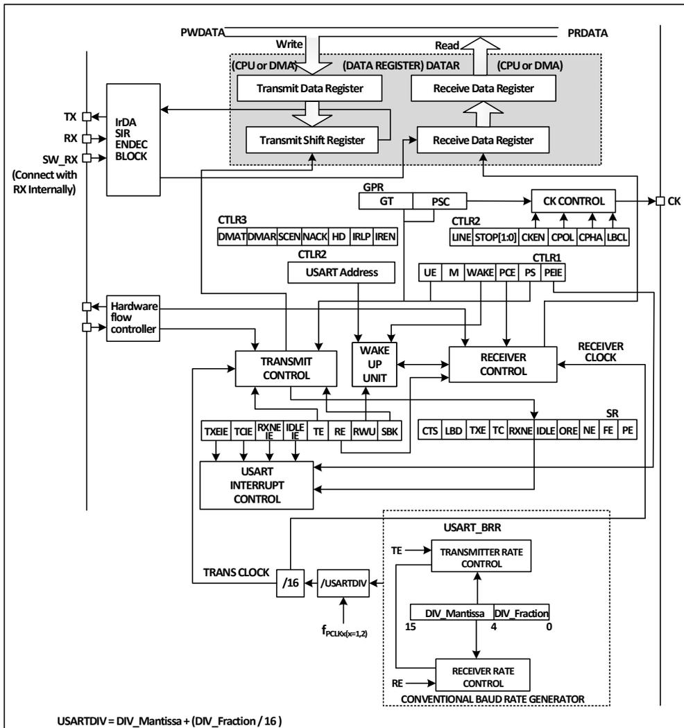
当 TE (发送使能位) 置位时，发送移位寄存器里的数据在 TX 引脚上输出，时钟在 CK 引脚上输
