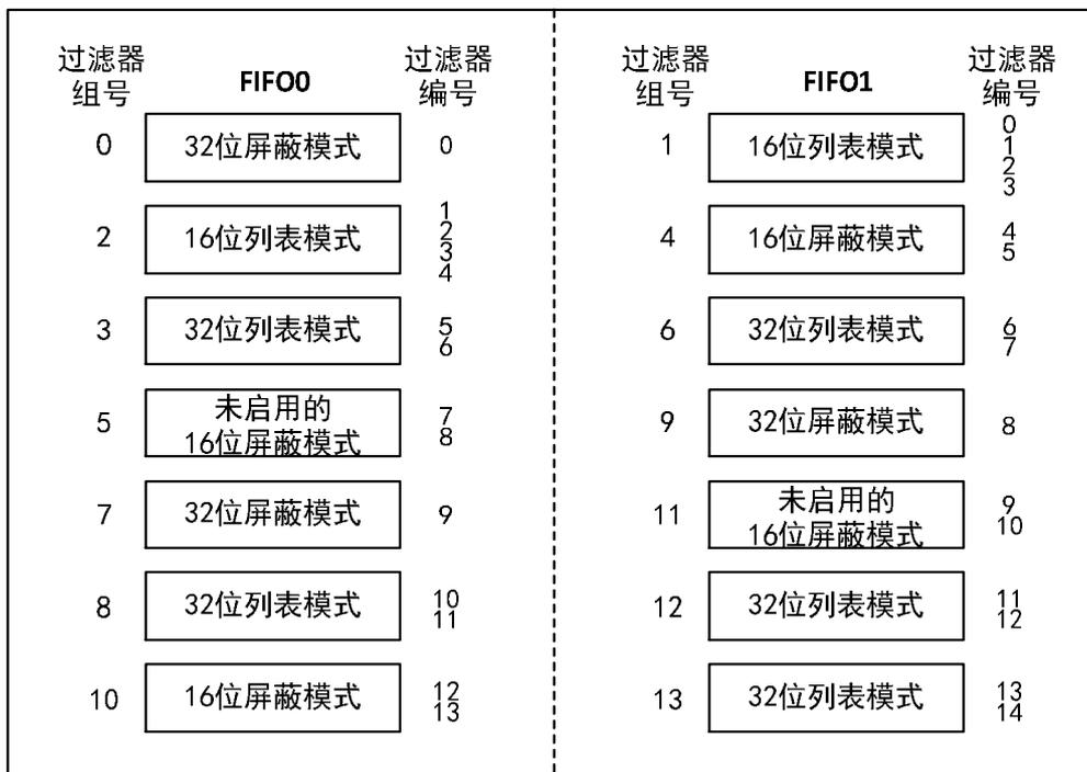
图 22-5 过滤器过滤示例
