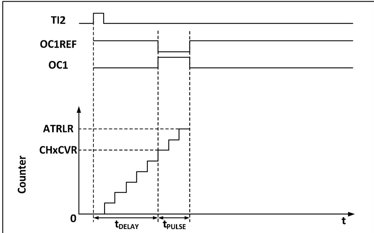
如图 15-4 所示, 需要在 TI2 输入引脚上检测到一个上升沿开始, 延迟  $T_{delay}$  之后, 在 OC1 上产生一个长度为  $T_{pulse}$  的正脉冲:
