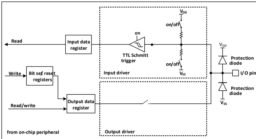
当 IO 口配置成输入模式时，输出驱动器断开，输入上下拉可选，不连接复用功能和模拟输入。在每个 IO 口上的数据在每个 APB2 时钟被采样到输入数据寄存器，读取输入数据寄存器对应位即获取了对应引脚的电平状态。
